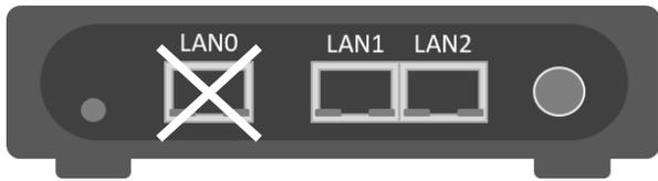
LAN0は、冗長ルータ機能用ポートです。通常のLANポートとして利用できませんのでご注意ください。LAN0ポートと固定回線のルータを接続すると、固定回線が優先され、固定回線の接続が不通時は、自動でU AIRの回線に切り替わります。
