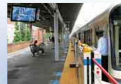
車掌がドア開閉操作をする際の安全確認用として、屋外サイネージ液晶ディスプレイを導入。画面に西日や直射日光があたる環境でも、視認性の高い映像を表示します。
