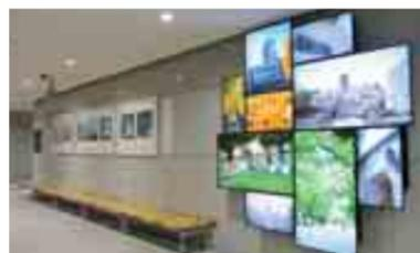
従来の枠にとらわれない大小・縦横混在の「風車型」のマルチディスプレイデジタルサイネージシステムを導入。
