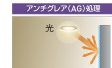
表面の凹凸を利用し、反射光を散乱させ、映り込みを低減
