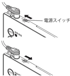
電源を切るには、電源スイッチをOFF側にスライドする
